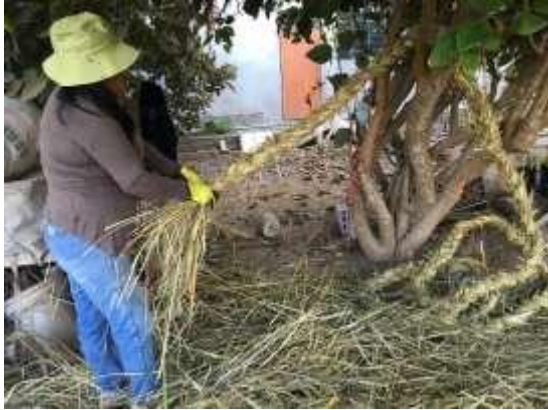
Foto 1. .Biosoga (Biorope) - una cuerda hecha con paja de vetiver biodegradable
